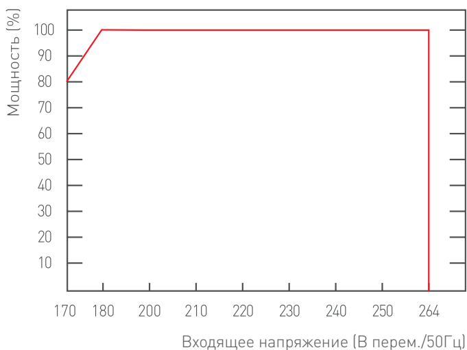
Рис. 2. – График зависимости номинальной мощности блоков питания от колебаний входящего напряжения.
